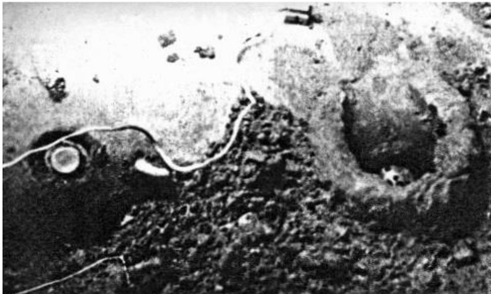
Voorbeeld van een Duitse bom met een Y-ontsteker. Van links naar rechts zijn te zien: de afgedekte ontstekerkop, de magnetische microfoon met draad naar een stethoscoop, en de kom van klei waarin de vloeibare zuurstof op de kop van de Y-ontsteker werd gegoten.
